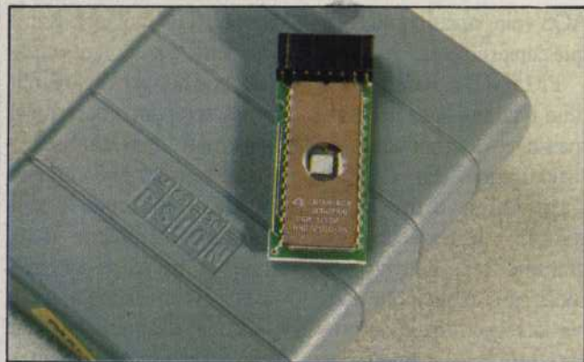
L'Eprom est capable d'enregistrer des données et de les conserver indéfiniment.
